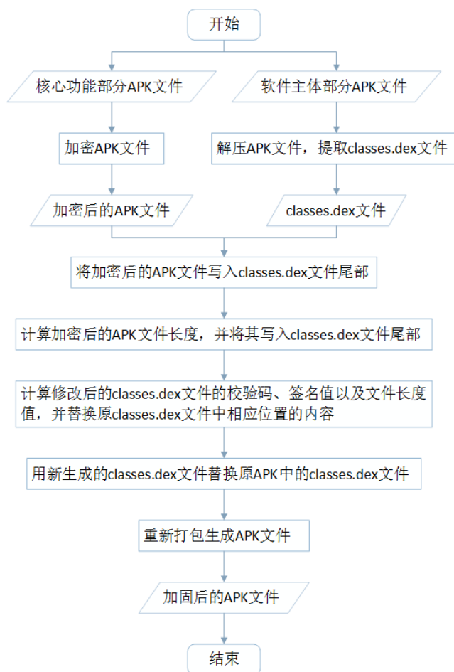
图 2 APK 加固流程图
