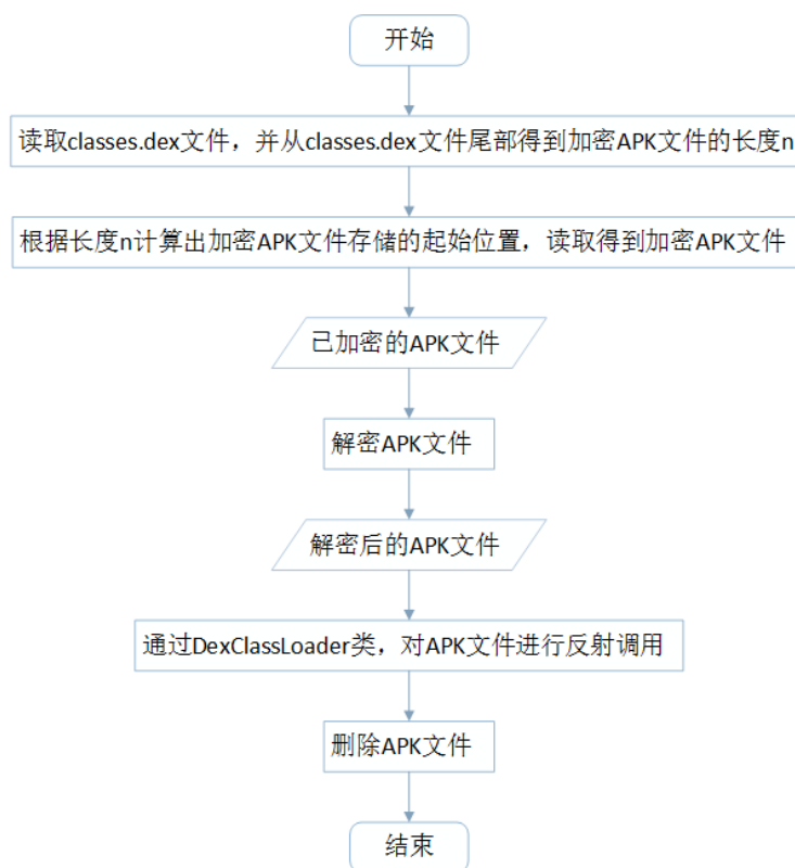
图 4 apk 动态加载流程图
