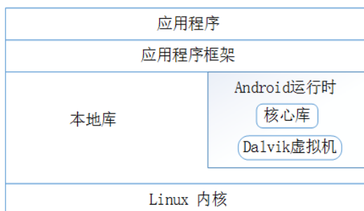
图 1 Android 系统架构图
