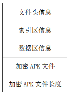
图 3 加固后的 classes.dex 文件结构
